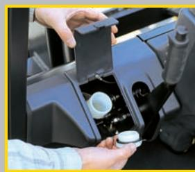
Il sensore elettrico nel serbatoio del liquido dei freni avvisa quando è necessario il rabbocco.
