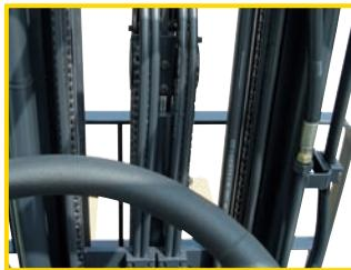
La disposizione di tutti i tubi idraulici e delle loro guide è stata riorganizzata per fornire una libera visibilità anteriore attraverso il montante. I tubi flessibili ausiliari sono allineati dietro le catene e i cilindri del montante.
