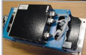
Il controller a corrente alternata della serie PRO 5 è una modernissima centrale di comando che comprende una scheda logica principale e 3 moduli di alimentazione indipendenti. Collegato direttamente ai sistemi della trazione e dell'impianto idraulico il controller gestisce e monitorizza le seguenti funzioni:
