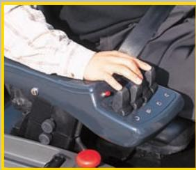
Il comando delle funzioni idrauliche a Mini-leve (opzionale) consente il movimento controllato e preciso del carico, letteralmente solo con un dito, per ridurre significativamente i movimenti e lo sforzo dell'operatore.
