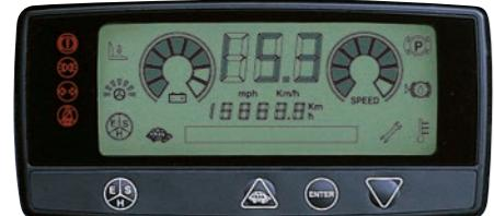
Una intelligente combinazione di LED e display LCD aggiorna costantemente il conducente sulle condizioni di funzionamento del carrello e permette l'accesso alle funzioni di programmazione e di diagnosi. I quattro pulsanti del display consentono di scegliere fra 4 modalità di erogazione della potenza: modalità Alte Prestazioni, modalità Standard, Risparmio Energia e Marcia Lenta.
