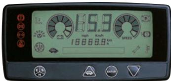
Una intelligente combinazione di LED e display LCD aggiorna costantemente il conducente sulle condizioni di funzionamento del carrello e permette l'accesso alle funzioni di programmazione e di diagnosi. I quattro pulsanti del display consentono di scegliere fra 4 modalità di erogazione della potenza: modalità Alte Prestazioni, modalità Standard, Risparmio Energia e Marcia Lenta.
