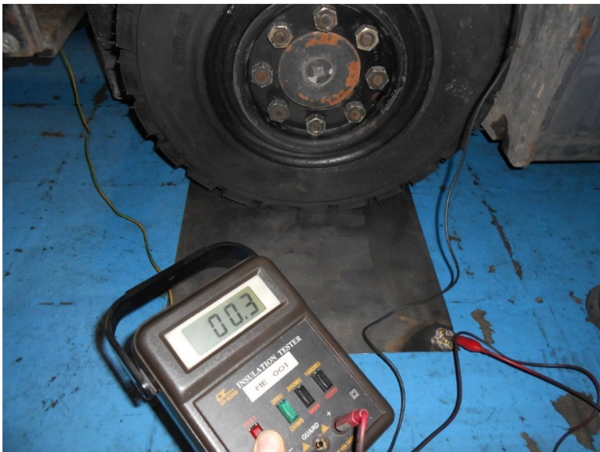
Verifica antistaticità gomme, eseguita dai tecnici della GPM Tregi
