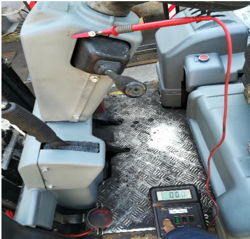
Verifiche di antistaticità delle plastiche, eseguita dai tecnici della GPM Tregi
