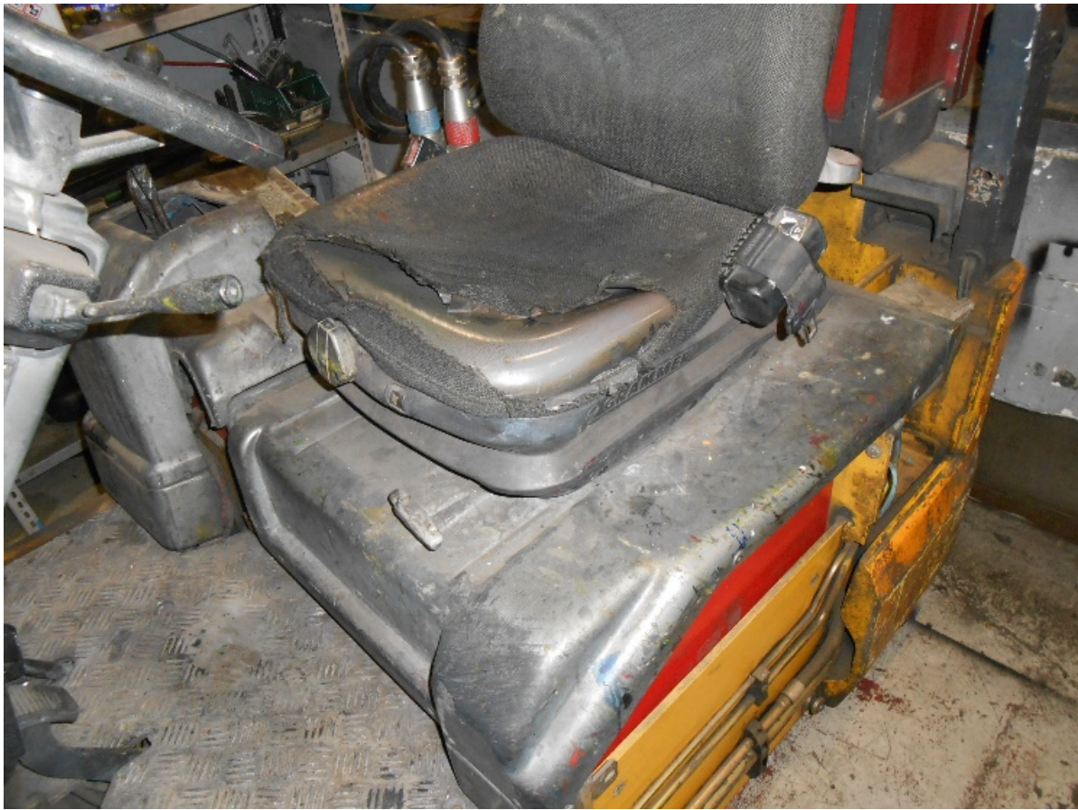
Sedile non più antistatico, quindi non idoneo ad operare in area pericolosa
