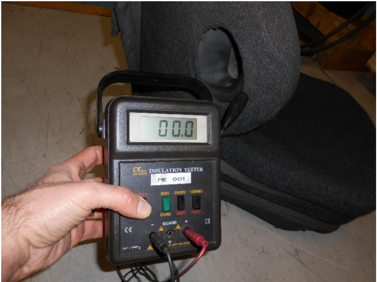
Verifica antistaticità rivestimento sedile, eseguita dai tecnici della GPM Tregi
