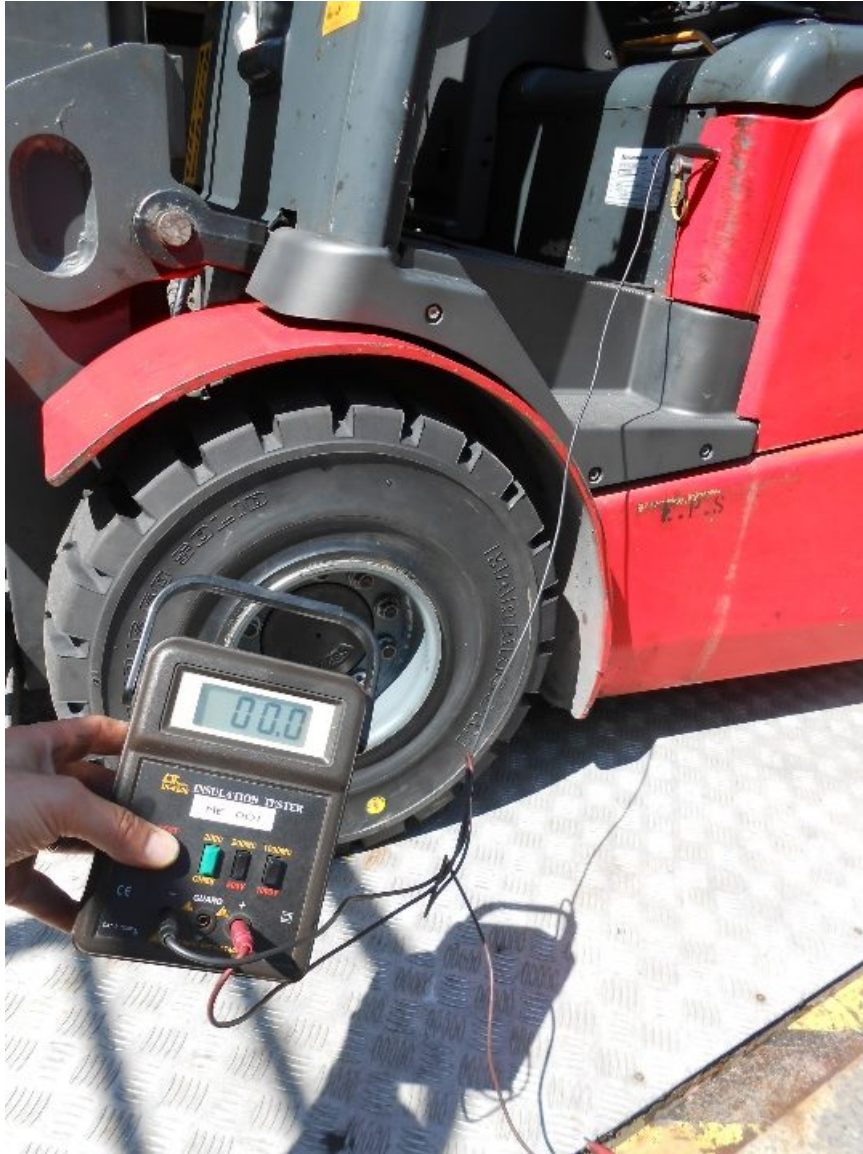
Verifica antistaticità gomme, eseguita dai tecnici della GPM Tregi
